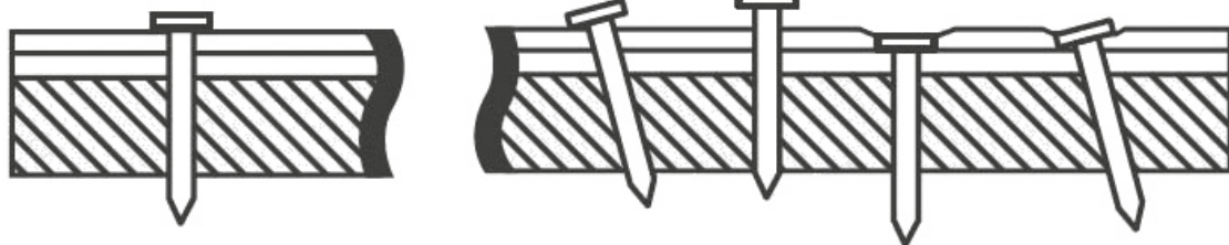
Рис. 3 Пример правильной забивки гвоздей при монтаже продукции.
